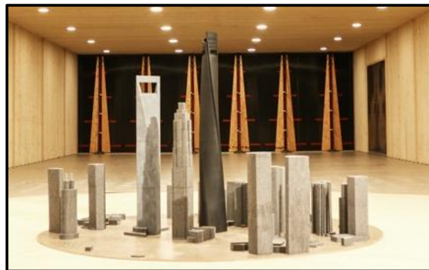
图 5: RWDI 的 24 英尺风洞测试 © RWDI
